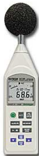
Figura 4-20 – Imagem do medidor de nível de pressão sonora utilizado
